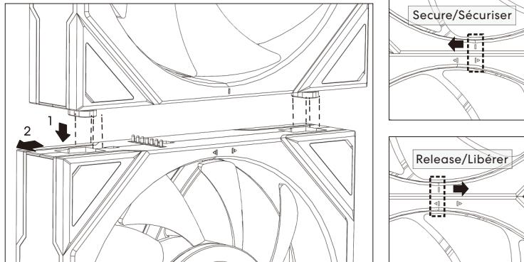
**Power Module Installation / 電源片安裝
