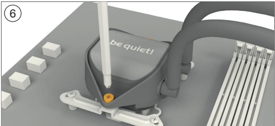
Placez le bloc CPU au centre des ponts de montage Intel (4) de manière à ce que ceux-ci permettent de visser le bloc CPU. Vous pouvez utiliser à cet effet un tournevis cruciforme ordinaire. Connectez ensuite la pompe et l'éclairage LED à l'adaptateur SATA (18).
