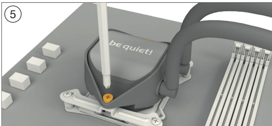
Placez le bloc CPU au centre des ponts de montage Intel (4) de manière à ce que ceux-ci permettent de visser le bloc CPU. Vous pouvez utiliser à cet effet un tournevis cruciforme ordinaire. Connectez ensuite la pompe et l'éclairage LED à l'adaptateur SATA (18).
