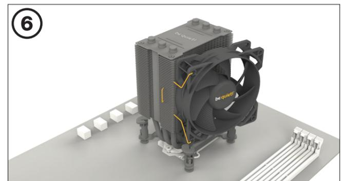
Fixez le ventilateur 92mm (2) sur l'unité de refroidissement (1) en utilisant les clips de fixation (4). Connectez le ventilateur au signal PWM de la carte mère.
