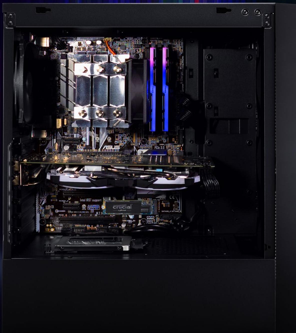
Une vision claire du matériel installé est possible à travers le côté gauche. Ceci est assuré par le panneau latéral du boîtier, qui est entièrement en verre trempé. Votre configuration peut donc être vue à l'intérieur de ce boîtier minimaliste. Afin que rien ne gêne la vision et que les composants intégrés soient mis en avant, il n'y a pas de vis visibles sur le panneau latéral. L'attachement est à l'arrière du boîtier et donc en dehors du champs de vision.
