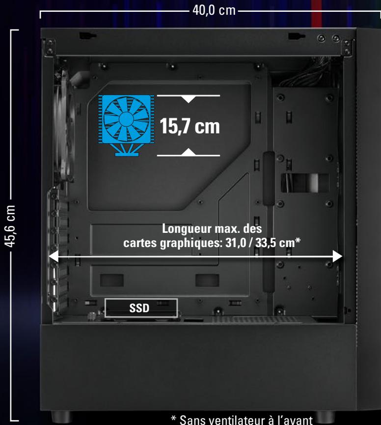
Avec sa taille compacte, le RGB Slider peut être facilement intégré aux configurations plus petites ou celles intentionnellement gardées minimalistes. Cependant, les composants de matériels plus larges peuvent aussi être facilement installés dans le boîtier. Le refroidisseur CPU peut mesurer jusqu'à 15,7 cm, ce qui laisse assez de place pour les cartes graphiques mesurant jusque 33,5 cm de longueur.
