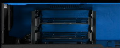
ENCOCHES OVALES POUR LE POSITION FLEXIBLE DE LA CAGE À DISQUE DUR
