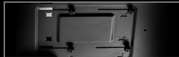
Encoches ovales pour le repositionnement du rack amovible pour disque dur/SSD
